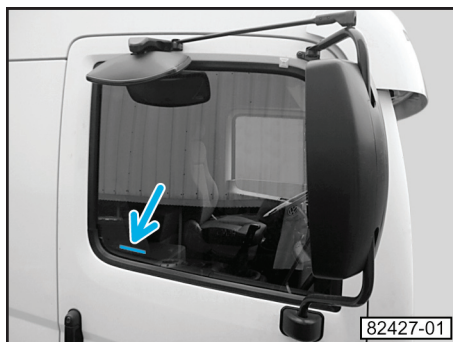
Grabación en el vidrio de la puerta, lado derecho.
