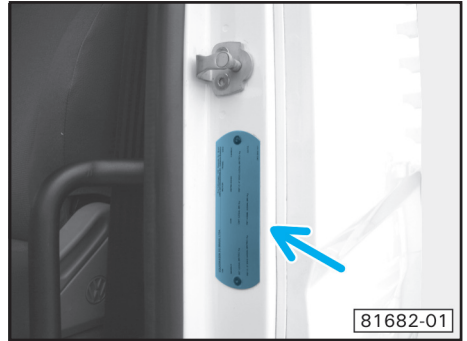
Los camiones Volkswagen tienen una plaqueta de identificación fijada en el batiente de la puerta del conductor.
